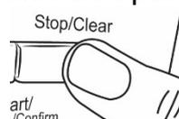
**Entsperren:** Drücken Sie im gesperrten Zustand die "STOP / CLEAR" -Taste für 3 Sekunden. Es ertönt ein langes "Piep", das darauf hinweist, dass die Sperre aufgehoben wurde. Das Sperrsymbol verschwindet vom Display.
