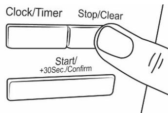
Nach der Hälfte der Grillzeit piept das Gerät zweimal, damit Sie das Essen wenden können. Um ein gleichmäßigeres Grillen zu erreichen, sollten Sie das Gargut umdrehen, die Tür schließen und dann „**START / + 30 SEC./CONFIRM**“ drücken, um den Garvorgang fortzusetzen. Wenn die Tür nicht geöffnet wird und das Gargut nicht gewendet wird, kann der Ofen weiter grillen, bis die Zeit abgelaufen ist.
