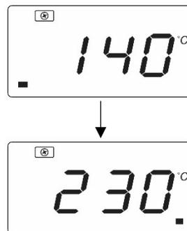
3) Sobald die gewünschte Temperatur angezeigt wird, drücken Sie zur Bestätigung die Taste „START / + 30 SEC./CONFIRM“,
