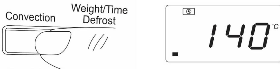
2) Drehen Sie das Wahlrad „TIMER / WEIGHT / AUTO“, um die gewünschte Temperatur auszuwählen. Hinweis: Die Temperatur kann in Intervallen von 10 Grad zwischen 140 Grad und 230 Grad eingestellt werden.
